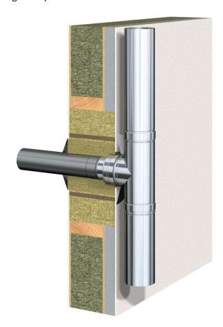
Die Innenseite von IGNIS PROTECT ULTRA besitzt eine Aluminiumkaschierung, für den luftdichten sicheren Anschluss an die bauseitige Blower-Door-Abdichtung, was nicht zuletzt die Energieeffizienz verbessert, sondern auch die Einbaumöglichkeiten erhöht. Die Außenseite ist als Tragschicht für den Außenputz ausgebildet. Außerdem ermöglichen die sieben herausnehmbare Rohrschalen eine feine Abstimmung an die Verbindungsleitungen:
